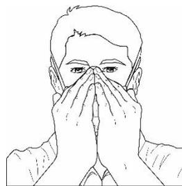
4. Antes de cada uso, execute um teste de verificação de vedação de pressão positiva e negativa. Para isso, cubra o respirador com as duas mãos com o cuidado de não alterar sua posição. Para a verificação de pressão positiva, exale suavemente. Para a de pressão negativa, inale suavemente. Se houver vazamento de ar em volta do nariz ou nas bordas do respirador, reajuste-o de acordo com estas Instruções de Colocação e Ajuste.
