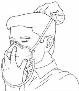
2a. Leve o respirador ao rosto cobrindo a boca e o nariz. Puxe o elástico superior, passando-o acima das orelhas e ajustando-o bem no alto da cabeça.
